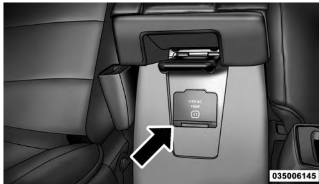
115 Volt Power Outlet
